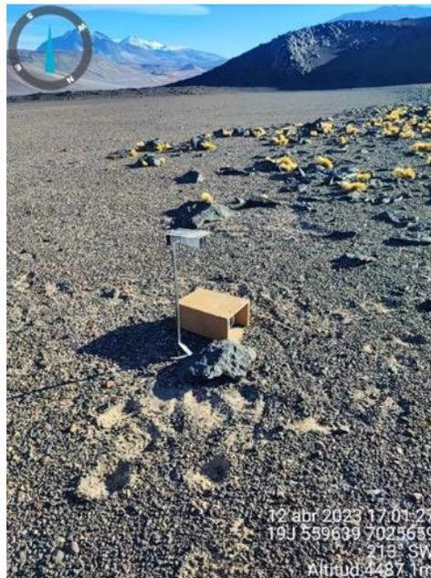
Fotografía 8. Cámara Eufy© y foco de luz infrarroja con detector de movimiento.
