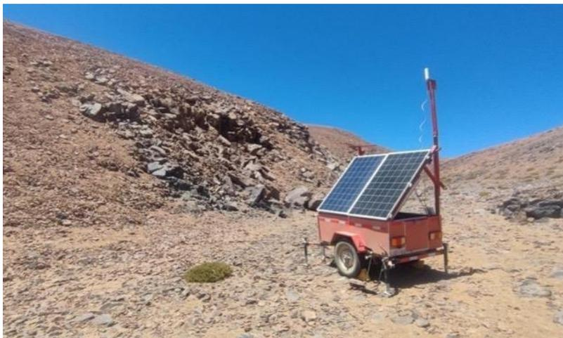
Fotografía 6. Carro de arrastre con sistema de generación de energía fotovoltaica, sistema de circuito cerrado de televisión y conexión a internet satelital.
